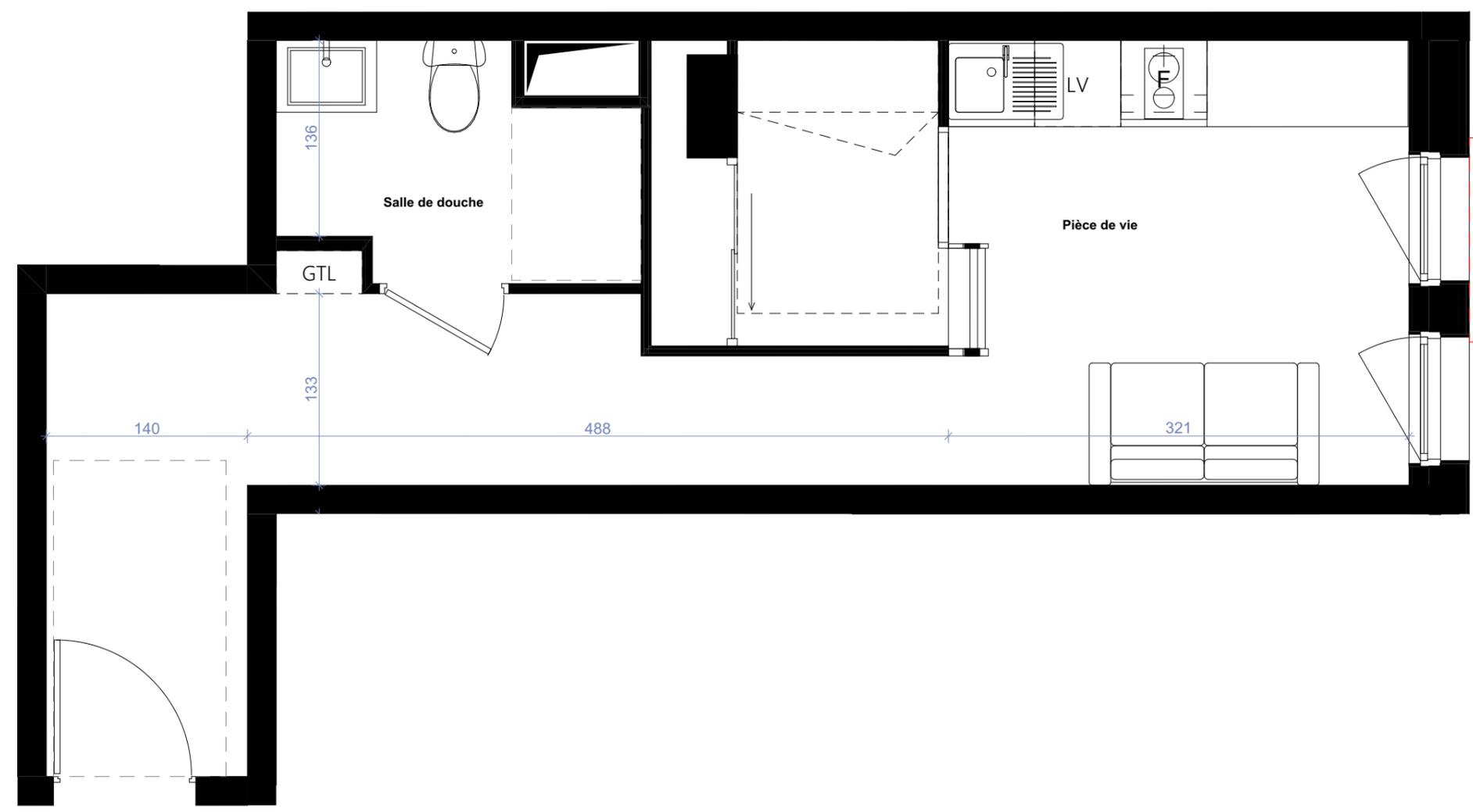
LEGENDE : PF : Porte-Fenêtre / F : Fenêtre / VR : Volet roulant / etel : Tableau électrique / Pl. : Placard / TRI : Emplacement tri sélectif / R : Emplacement réfrigérateur / LL : Emplacement lave-linge / LV : Emplacement lave-vaisselle / Soffite, Faux-plafond :
