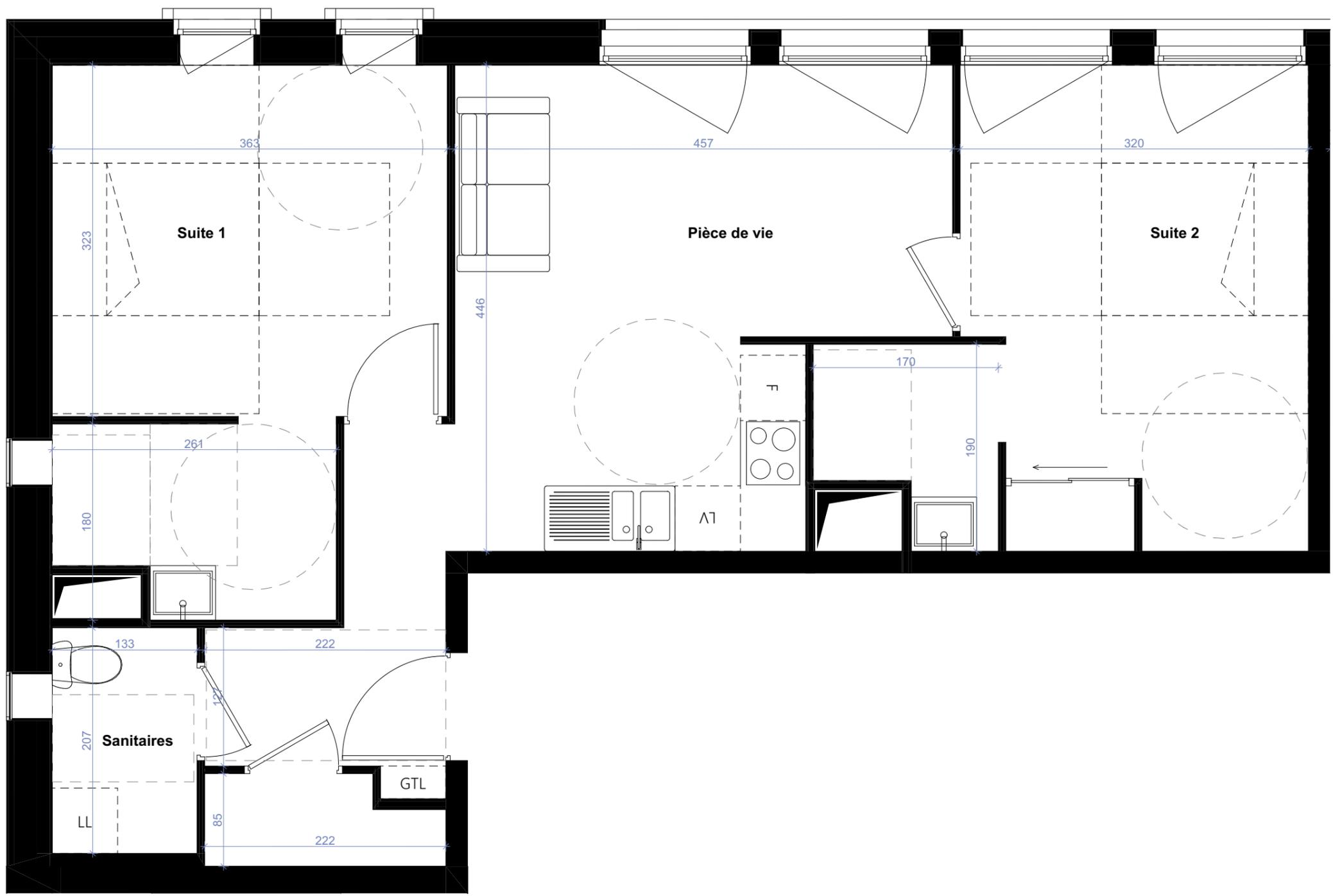
LEGENDE : PF : Porte-Fenêtre / F : Fenêtre / VR : Volet roulant / etel : Tableau électrique / Pl. : Placard / TRI : Emplacement tri sélectif / R : Emplacement réfrigérateur / LL : Emplacement lave-linge / LV : Emplacement lave-vaisselle / Soffite, Faux-plafond :
